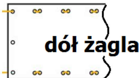
Rys 1. Poprawne mocowanie żagla
