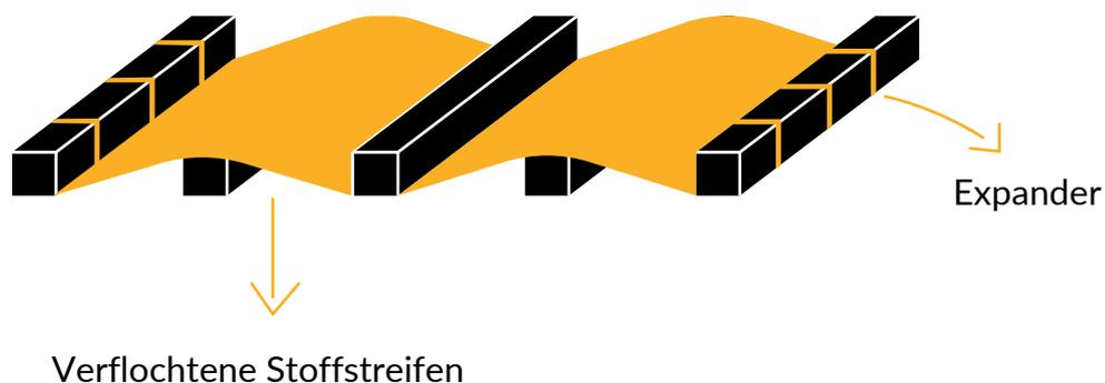
Abb. 2. Vorgeschlagene Methode zur Installation dieses Sonnenschut
